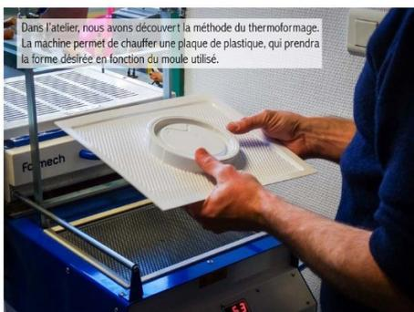
Dans l'atelier, nous avons découvert la méthode du thermoformage. La machine permet de chauffer une plaque de plastique, qui prendra la forme désirée en fonction du moule utilisé.
